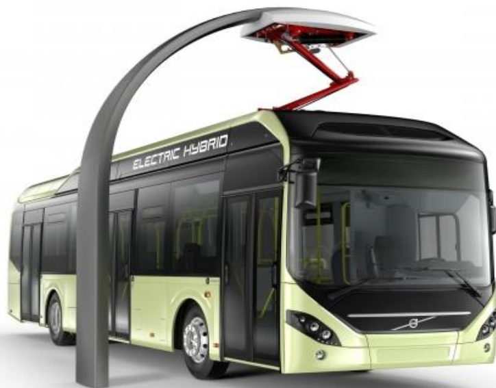
Rysunek 2. Pantografowa stacja ładowania autobusów hybrydowych
